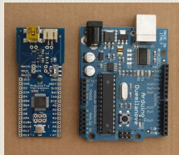
ARDUINO FIO VS ARDUINO UNO
